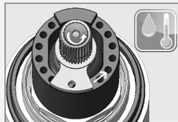
**(GER)** Setzen Sie den Stift in das entsprechende Loch im Temperaturring, um die gewünschte Temperatur dauerhaft einzustellen.
